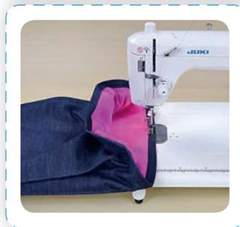
Jetzt werden die seitlich noch nicht abgesteppen Kanten geschlossen. Durch das gleichzeitige Mitnähen vom Innenfutter, wird auch das Futter fixiert und verhindert, dass es nach außen geschoben wird.
